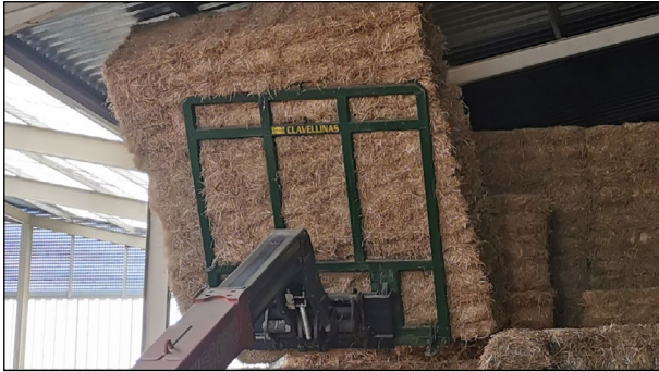
Foto 10. Accesorios de elevación con resguardos.
