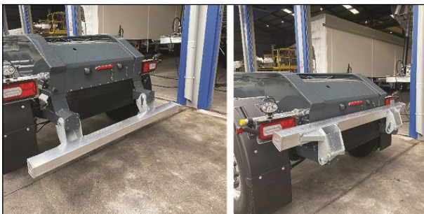
Figura 14. Sistema anti-empotramiento neumático desplegado y recogido.
