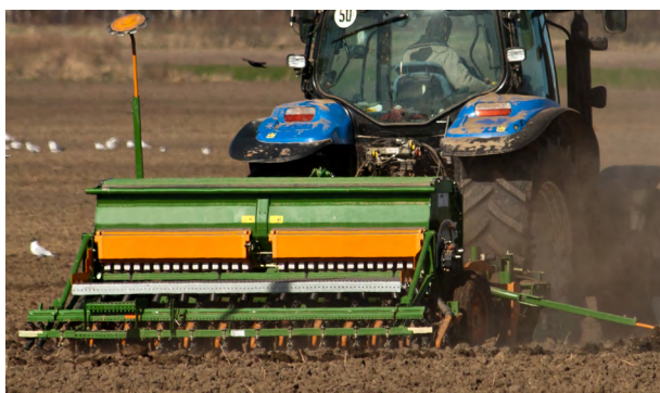
Figura 1a. Sembradora en líneas.
