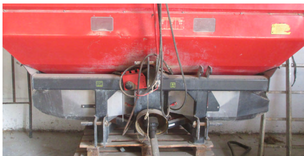
Figura 16. Resguardo frente a la proyección de fertilizante.
