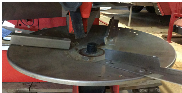
Figura 7. Discos rotatorios con paletas.
