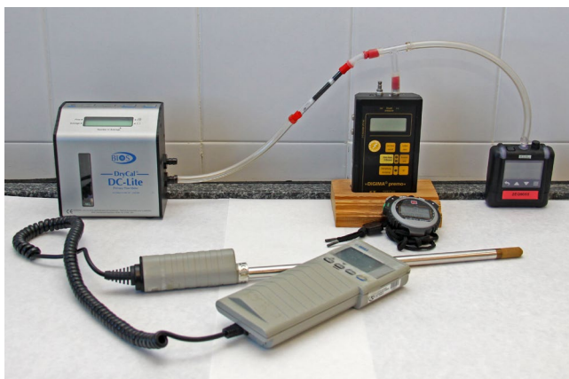
Figuras 4 y 5. Montaje realizado para ensayar la pérdida de carga aportada por los muestreadores de gases y vapores y de materia particulada.
