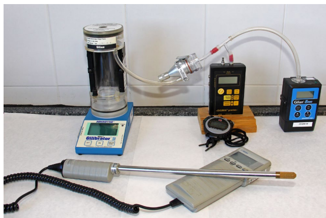
Figuras 4 y 5. Montaje realizado para ensayar la pérdida de carga aportada por los muestreadores de gases y vapores y de materia particulada.
