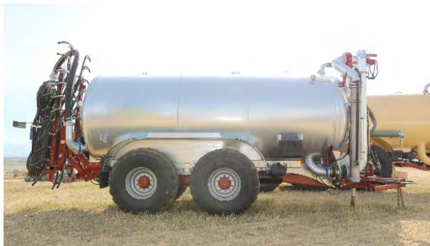
Figura 3. Cisterna de acero galvanizado.
