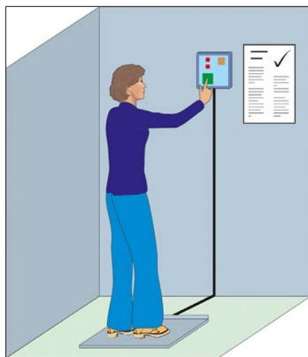
Figura 3. Verificación de la resistencia de puesta a tierra previa entrada a una zona ATEX.
