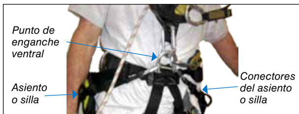
Figura 1. Anclaje al arnés de un asiento manufacturado.
