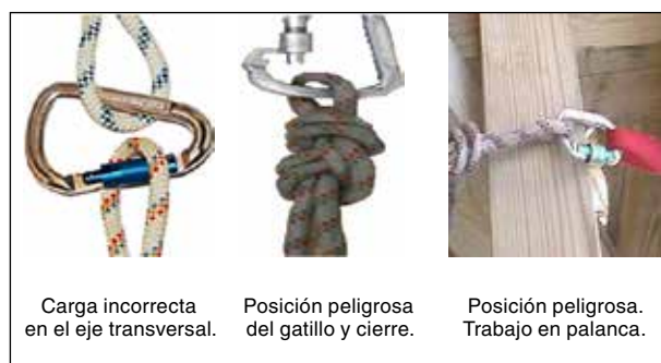
Figura 11. Ejemplos de utilización incorrecta de conectores.
