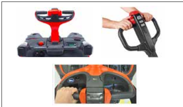
Figura 7. Detalle de modelos de manillar o timón con los mandos incorporados.
