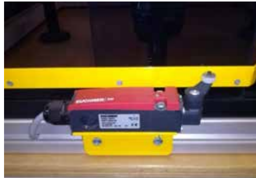
Figura 3. Acción mecánica directa de una leva sobre un interruptor de posición.
