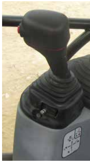
Figura 11: Órgano de mando tipo joystick.
