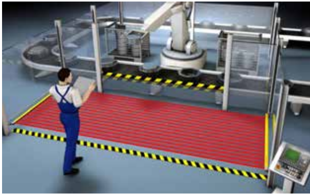
Figura 4. Cortina fotoeléctrica instalada en posición horizontal que permite detectar la presencia del operador en la zona peligrosa. Fuente: Leuze electronic S.A.U.
