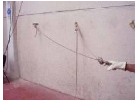
Figura 16. Sistema realizado mediante tres ochos.
