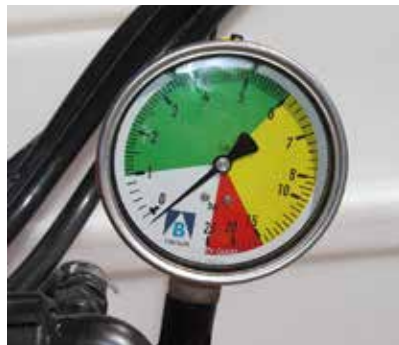
Figura 17. Manómetro con indicación de la presión que supera la presión máxima de trabajo (sector rojo).
