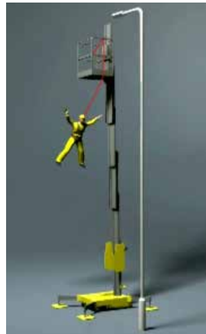
Figura 14. Caída con efecto péndulo
