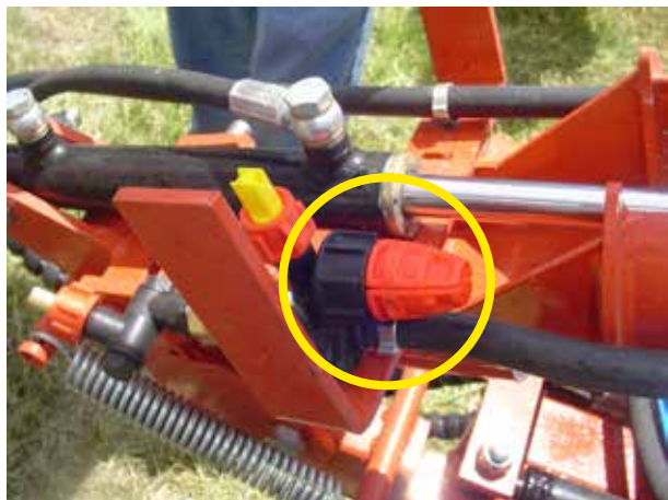
Figura 7. Boquilla con dispositivo antigoteo.
