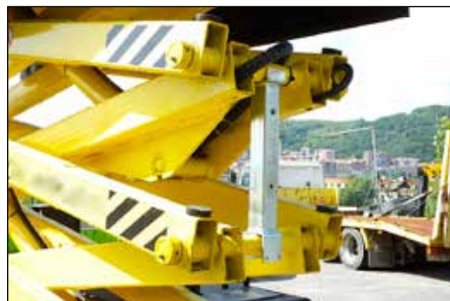
Figura 16. Sistema mecánico de seguridad. Detalle.
