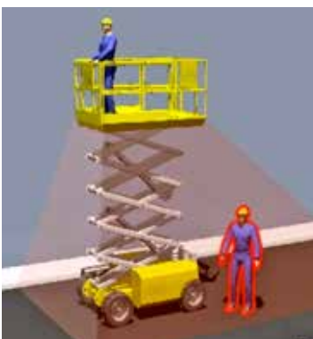
Figura 22. Control de presencia de operarios en proximidad.
