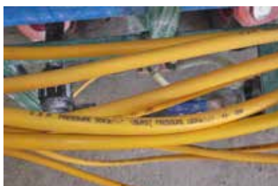
Figura 20. Indicación de la presión máxima del conducto
