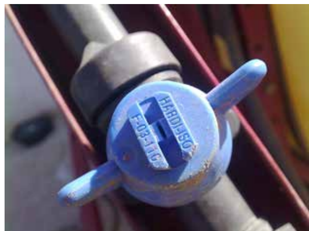
Figura 11. Boquilla marcada según código ISO.
