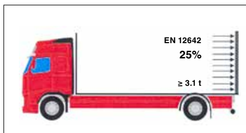
Figura 7. Resistencia de la pared posterior.
