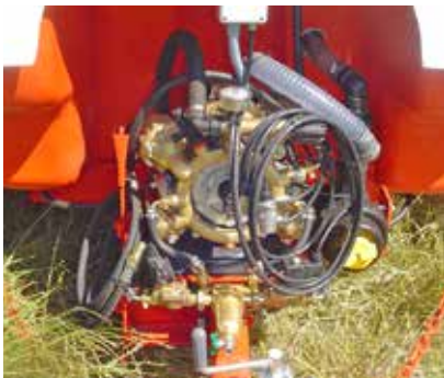
Figura 16. Manómetro mal ubicado, ya que no permite la lectura desde el puesto de conducción.
