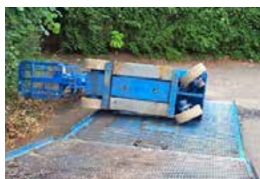
Figura 2. Vuelco de la PEMP durante la descarga.
