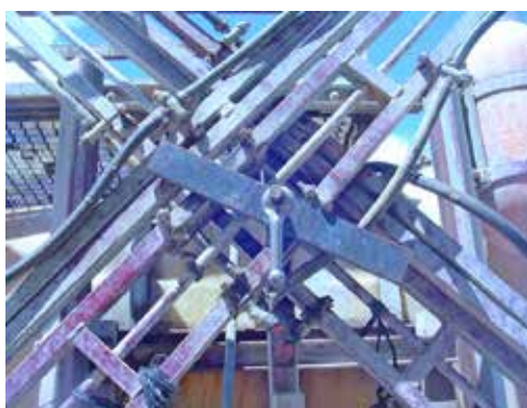
Figura 7. Dispositivo de retención de la barra de pulverización.
