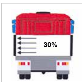
Figura 6. Resistencia de las paredes laterales.
