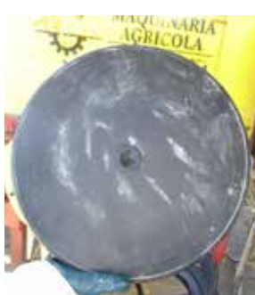
Figura 13. Orificio compensador de presiones en la tapa del depósito.
