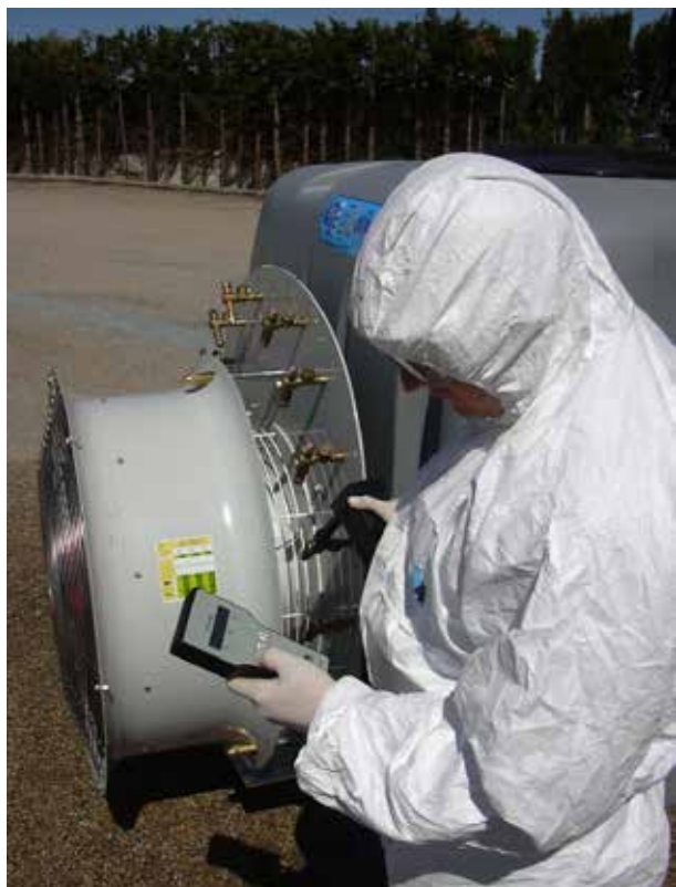
Figura 6. Ensayo de distribución vertical en un atomizador: medición del caudal de las boquillas.
