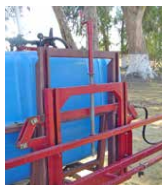
Figura 8. Dispositivo manual de regulación de la altura de la barra.
