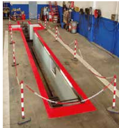
Figura 4. Zona de acceso al foso delimitada con barreras.
