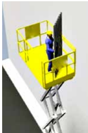
Figura 28. Aumento de la resistencia al viento.
