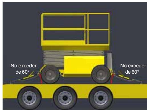
Figura 11. Tensado sobre lados opuestos de la carga.
