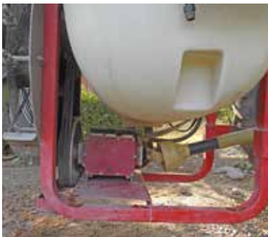
Figura 2. Atrapamiento en la transmisión de potencia al ventilador (poleas y correas sin resguardo).
