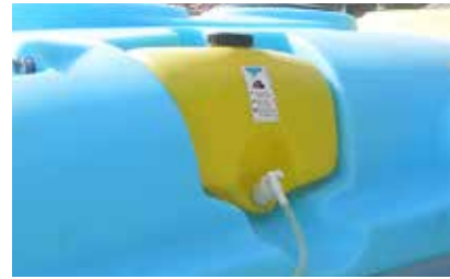
Figura 22. Depósito de agua limpia.
