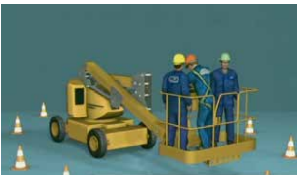
Figura 18. Plataforma de trabajo con exceso de personas
