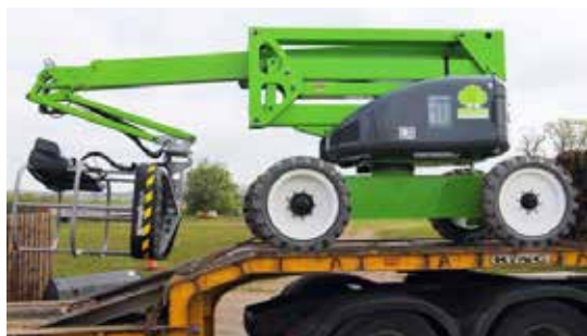
Figura 10. Amarre por rozamiento de una PEMP.
