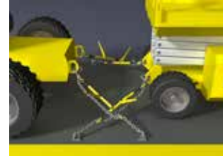
Figura 17. Carga correctamente asegurada.
