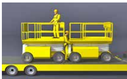
Figura 7. Atrapamiento entre PEMP.
