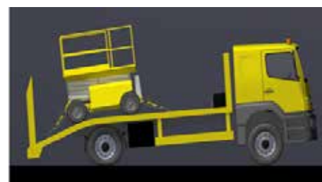
Figura 3. Sobrecarga eje trasero.
