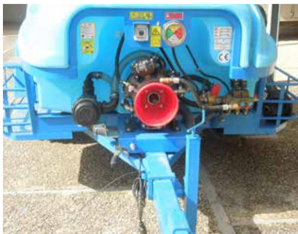
Figura 4. Dispositivos de regulación y control del pulverizador.
