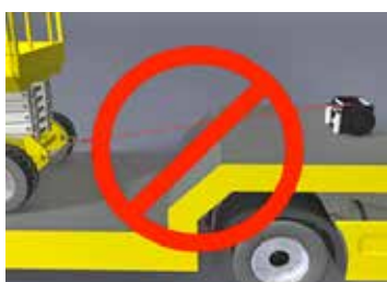
Figura 10. Utilizar el cabrestante como accesorio de amarre.
