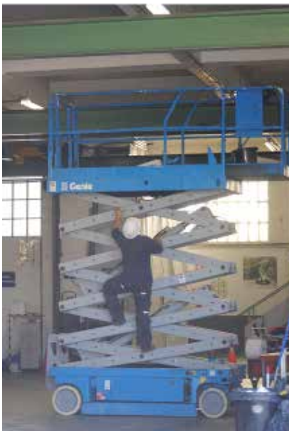
Figura 11. Subir/bajar, al/desde la plataforma de trabajo por la estructura extensible
