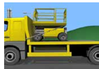
Figura 9. Golpe de la PEMP contra la cabina del vehículo.
