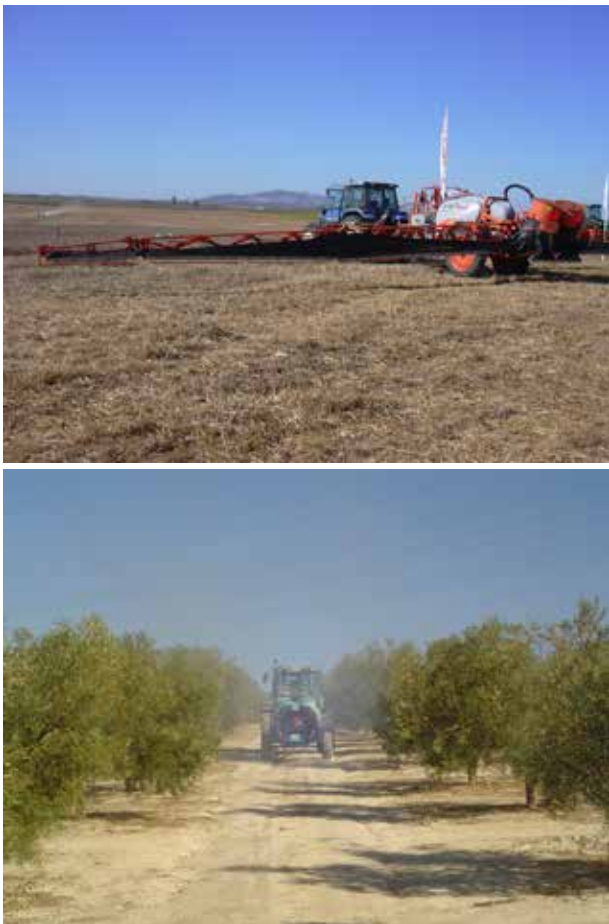
Figura 1. Ejemplos de máquinas para la aplicación de plaguicidas: pulverizador hidráulico de chorro proyectado (barra) y de chorro transportado (atomizador).
