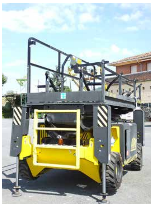
Figura 6. Plataforma de trabajo con protecciones perimetrales plegables.
