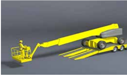
Figura 13. Descarga de la PEMP con la cesta lo más cerca posible del suelo.
