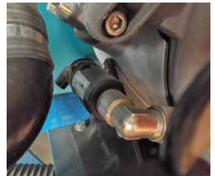
Figura 18. Válvula de seguridad. Se observa que está mal instalada ya que el retorno no lo hace al depósito.
