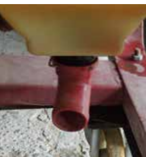
Figura 14. Dispositivo de vaciado del depósito.
