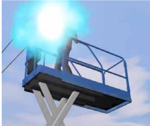
Figura 23. Contacto eléctrico directo con una línea eléctrica aérea de AT
