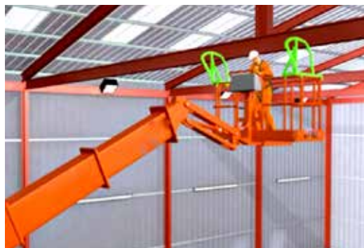
Figura 26. PEMP con sistema antiatrapamiento.
