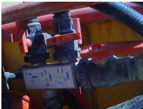
Figura 8. Mando del sistema de limpieza del circuito de líquido de la máquina.
