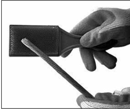
Figura 1. Limpieza de conductores.
